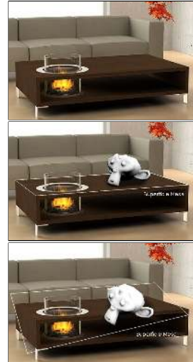
Figura 4.19: Arriba: Escena real. El problema del registro trata de calcular la posición de la cámara real para poder dibujar objetos virtuales correctamente alineados. Centro: Registro correcto. Abajo: Registro incorrecto.
