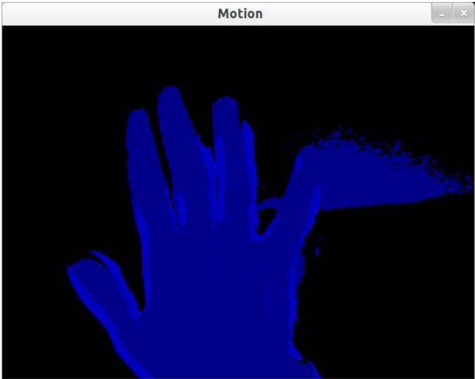
Figura 4.10: Detección del movimiento capturado. En azul aquellos pixels donde se ha localizado movimiento. En negro el fondo estático.
